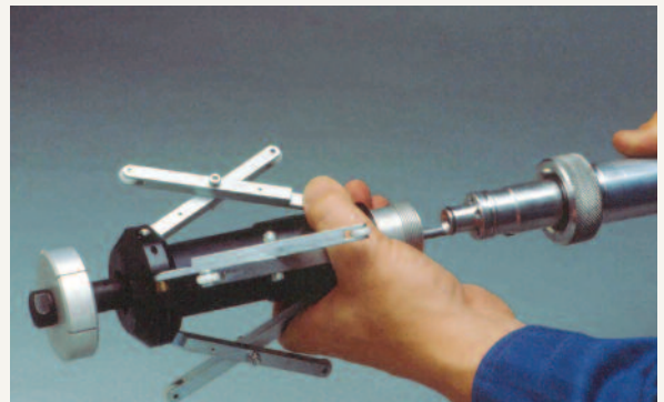
Orbiter I reviste tuberías entre las 3.5 y 7 pulgadas de diámetro.
