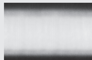
Pintura de látex a través de una boquilla HEA 517 a 1,000 PSI
