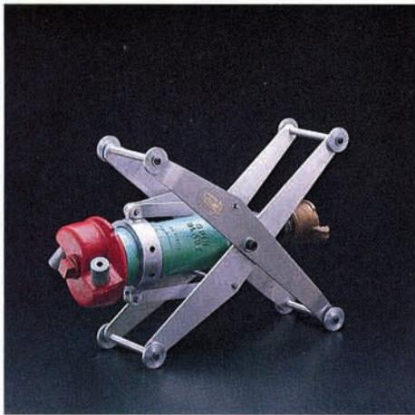
Existen dos aparatos centradores para el SpinBlast: el 03641 para diámetros de 8" hasta 17"; y el 04971 para diámetros de 12" hasta 24". Para tuberías con diámetros interiores de 36" hasta 60", existe el SpinBlast Grande que utiliza boquillas largas y el aparato centrador 10560. La tabla inferior muestra las combinaciones de boquillas y aparatos centradores disponibles.
