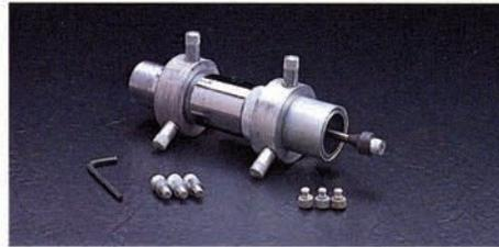
Se ofrece el HolloBlast con boquillas de dos orificios; de 1/2" que requiere 200 cfm y de 5/8" que requiere 350 cfm. Se dispone de dos aparatos centradores para el HolloBlast. La herramienta, por sí sola, cabe dentro de tuberías de 2" D.I. El Modelo 01124 es para diámetros interiores de 3" hasta 5", en incrementos de 1/2". El Modelo 01131 es ajustable y cubre todos los diámetros interiores desde 5" hasta 12".
